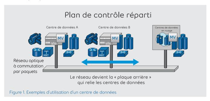
La technologie de longueur d'onde peut servir de plaque arrière entre les centres de données, assurant la transmission haute vitesse et à faible latence des données et des applications ainsi que l'interconnexion des serveurs et des ressources de stockage, permettant une surveillance améliorée du service.
